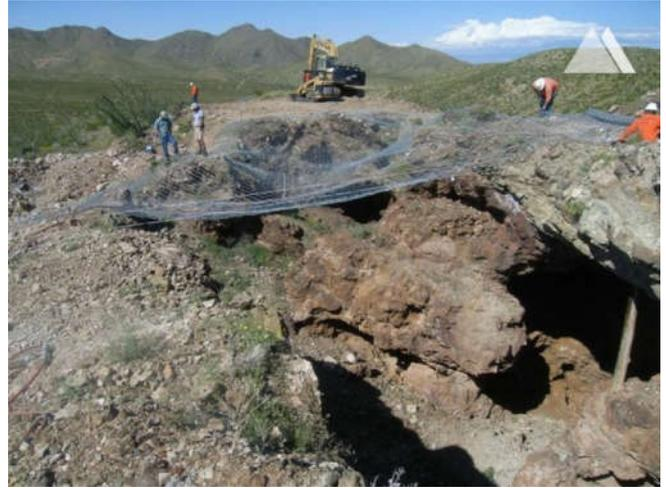
**TEST RESISTENZA STATICA DELTAXSAFE 4800 Kg al Mq!!**
