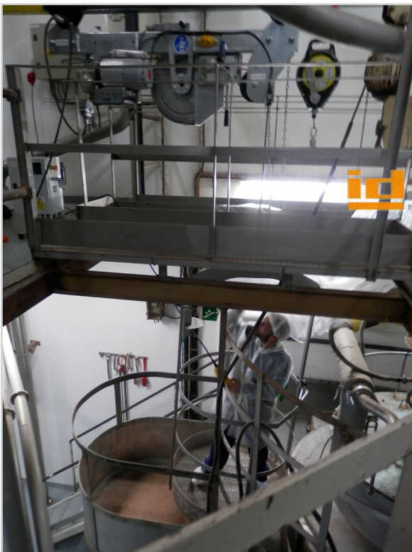
APLICACIÓN DEL EQUIPO DE DESCENSO AVAHO-S CON CESTA CIRCULAR Ø1 m EN TOLVA INDUSTRIAL
