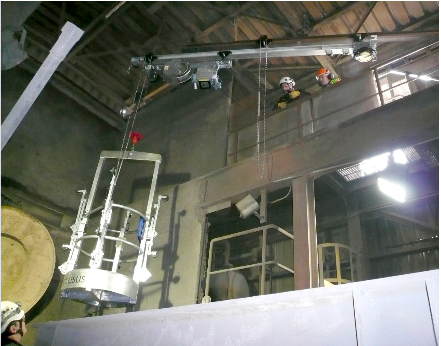
APLICACIÓN DEL EQUIPO DE DESCENSO AVAHO-S CON CESTA CIRCULAR Ø1 m EN TOLVA INDUSTRIAL
